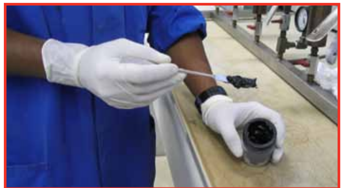
Huile moteur très boueuse (contamination par la suie)
