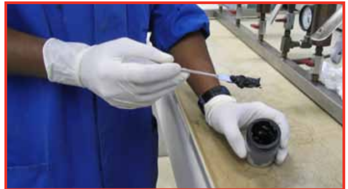
Une huile moteur soumise à une surchauffe intense
